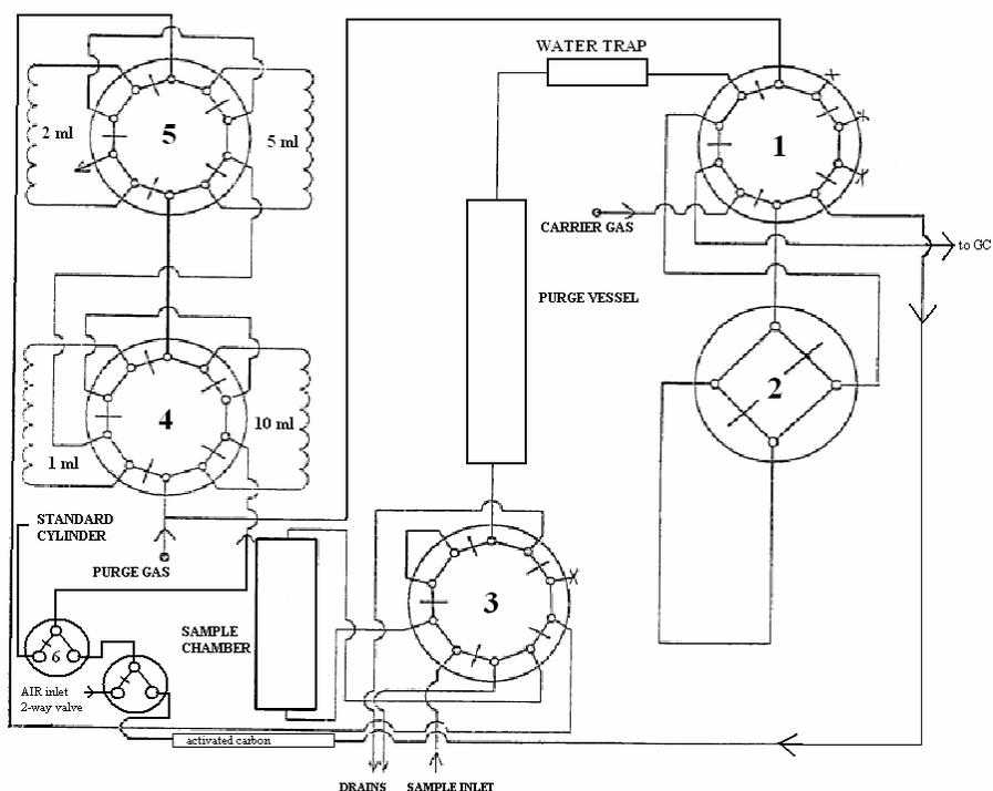
**Figure 14. Freon System Diagram.**
